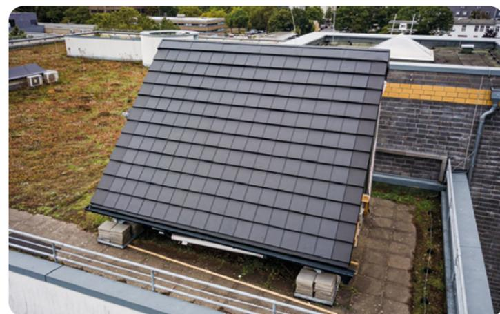
Das mit der Solardachpfanne eingedekte Testdach.
