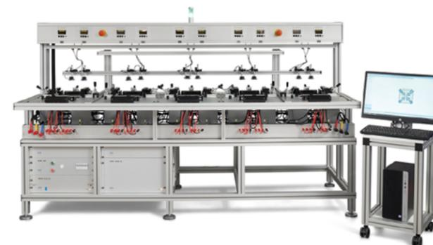
Gemeinsam mit Herstellern wurde eine Prüfeinrichtung für DC-Zähler entwickelt. (Foto: EMH Energie-Messtechnik GmbH)
