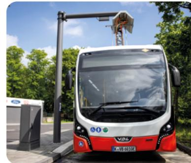
**Umgewandelte Bremsenergie, zwischengespeichert in 288 Second-Life-Batterien, liefert den Ladestrom für E-Busse und DC-Ladesäulen für E-Autos.**
