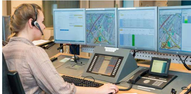
Dispositionsplatz mit Monitoren für Leitungs- und Straßenkarten, Dispositionsverfügbarkeiten und Antworteingaben aus der intelligenten Abfragestruktur.
