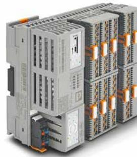
**Die PLCnext-Steuerung AXC F 2152 lässt sich flexibel um die jeweils benötigten Standard- und Funktionsmodule erweitern.**
