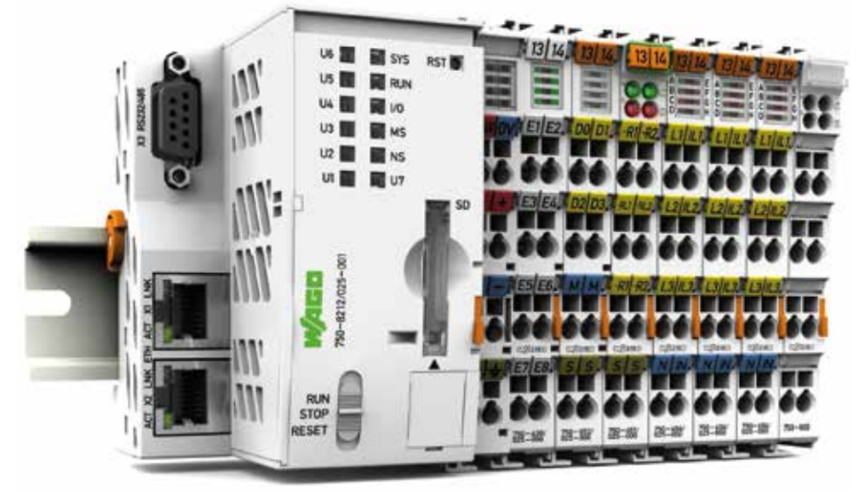
Der WAGO Fernwirkcontroller der 2. Generation ist eine speicherprogrammierbare Steuerung (SPS) mit diversen Schnittstellen. Ganz nach Bedarf lassen sich daran 3- oder 4-Leiter-Messkarten sowie Digital-eingangs- und -ausgangsmodule für die Steuerung einer Mittelspannungsschaltanlage anreihen. (Foto: WAGO GmbH & Co. KG)
